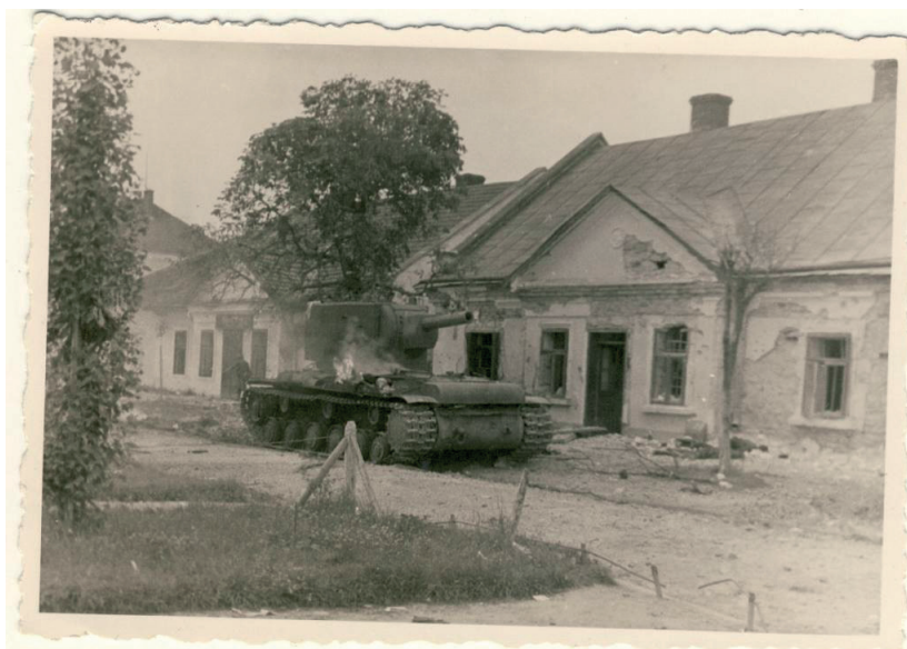
Рис. 1. Czołg KW-2 na początku bitwy w centrum miasta. Płonie skrzynka narzędziowa z częściami zamiennymi i narzędziami przechowywanymi w oleju, podpalona zapewne pociskami 37 mm (źródło: Л. Войтович, Загадки „миколаївських” танків , http://mykolayiv.org/detail/zagadki-mikolayivskih-tankiv/photo/ , dostęp: 15 VII 2021)
