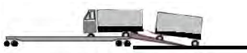
Rysunek 1.6. Technologia przewozu typu ruchoma droga
