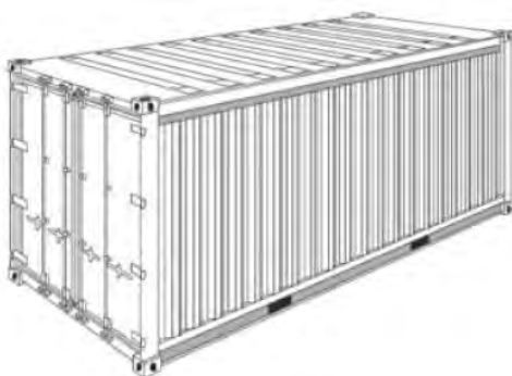
Rysunek 2.3. Kontener zamknięty z wentylacją
