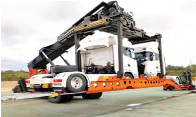
Bimodalny: specjalna naczepa siodłowa jako „wagon” z wymiennymi wózkami jezdnymi
