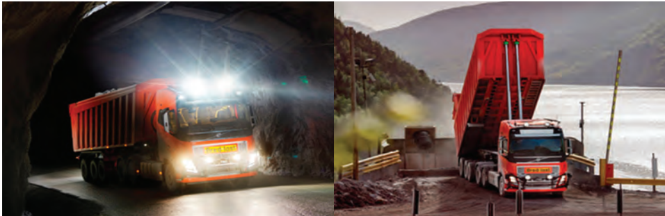
Ilustracja 47. Samobieżne ciężarówki Volvo przejeżdżają przez 5 km tuneli i wyładowują wapień do kruszarki w pobliskim porcie
