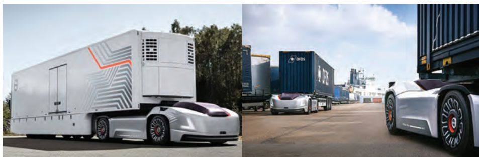
Ilustracja 49. Autonomiczna ciężarówka Vera i ciągnik siodłowy firmy Volvo napędzane wyłącznie energią elektryczną
