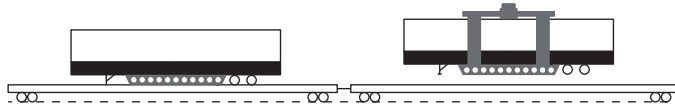
Piggy Back (na barana): naczepy siodłowe i nadwozia wymienne ładowane dźwigiem na wagony kieszeniowe
