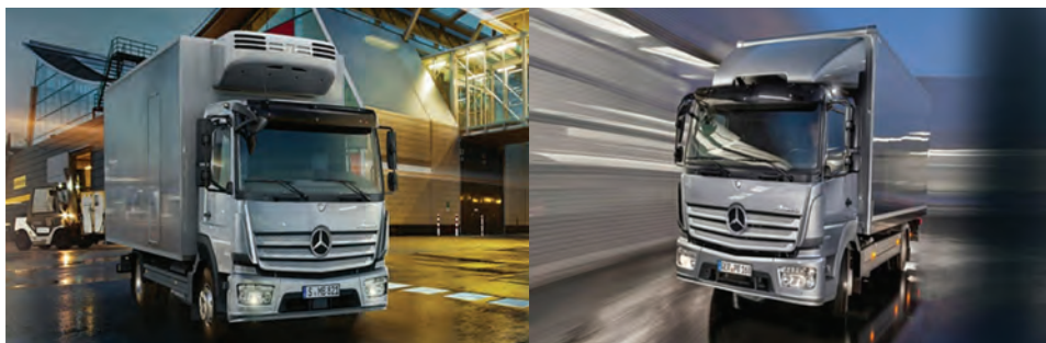
Ilustracja 4. Pojazd ciężarowy o nadwoziu uniwersalnym do dopuszczalnej masy całkowitej od 3,5 do 7,5 t oraz pojazd ciężarowy o nadwoziu specjalizowanym typu chłodnia
