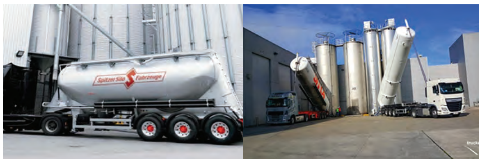
Ilustracja 8. Naczepy typu silos leżący – dolnozsypanie oraz silos ze zbiornikiem podnoszonym – kiprowanie
