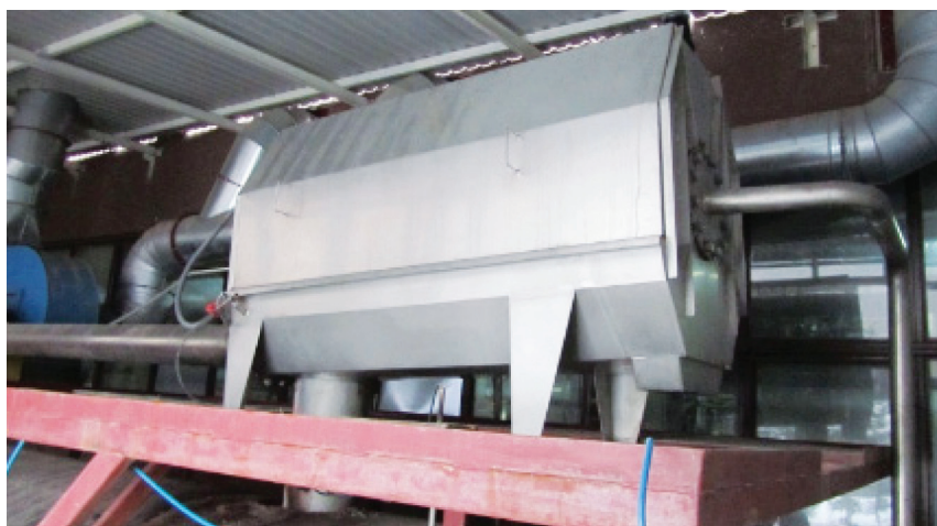
Fot. 3. Samoczyszczący filtr siatkowy, tzw. „łapacz bębnowy” firmy PFTechnology Sp. z o.o.
